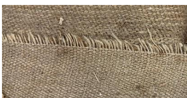
Figure 46 : Lisière des textiles de type N°1 © HE-Arc, 2022, Laura Flückiger
