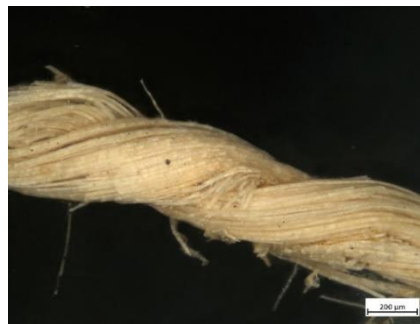
Figure 43 : Vue microscopique d'un fil de torsion S (agrandissement 50x, Dark Field) © HE-Arc, 2022, Laura Flückiger
