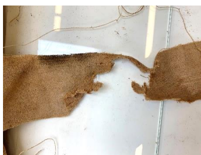
Figure 91 : Déchirure et lacune (textile N°1) © HE-Arc, 2022, Laura Flückiger
