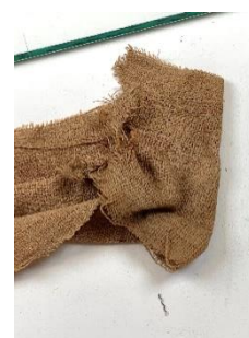
Figure 92 : Déformation (textile N°1) © HE-Arc, 2022, Laura Flückiger
