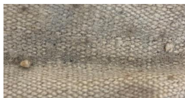
Figure 45 : Nœuds visibles dans le tissage © HE-Arc, 2022, Laura Flückiger
